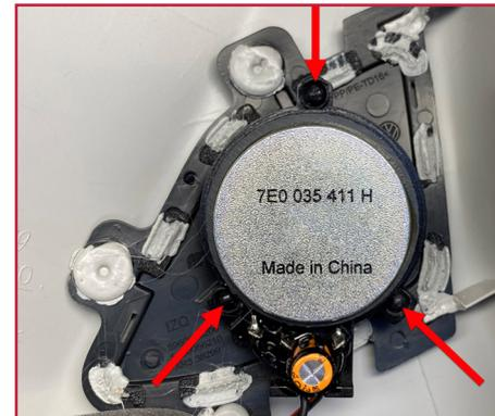
△ **Profi Tipp:** Wir empfehlen, den Bereich hinter dem Lautsprecher mit einer Dämmmatte zu bekleben, um Resonanzen zu verringern. Fragen Sie Ihren Fachhändler nach EMPHASER EM-DM2 – diese Matte ist eine Kombination aus Alubutyl und offenporigem Schaum und für dieses Fahrzeug perfekt geeignet.
