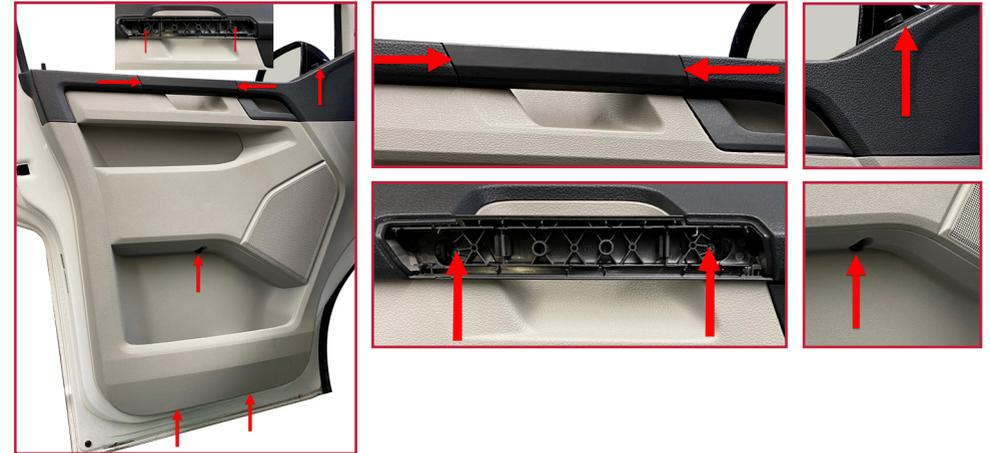
Zum Entfernen der Nieten benutzen Sie einen Metallbohrer mit 7,5 mm Durchmesser oder grösser und bohren vorsichtig den Nietenkopf ab. Nehmen Sie den Lautsprecher heraus und entfernen Sie die Reste der Nieten mit einer 9 mm Nuss und einer Rohrzange: Die 9 mm Nuss halten Sie hinter die Niete. Die eine Wange der Rohrzange liegt auf der 9 mm Nuss auf, die andere Wange auf der Niete. Drücken Sie die Rohrzange zusammen; die Niete wird von der Nuss aufgefangen und das Blech bleibt unbeschädigt.
